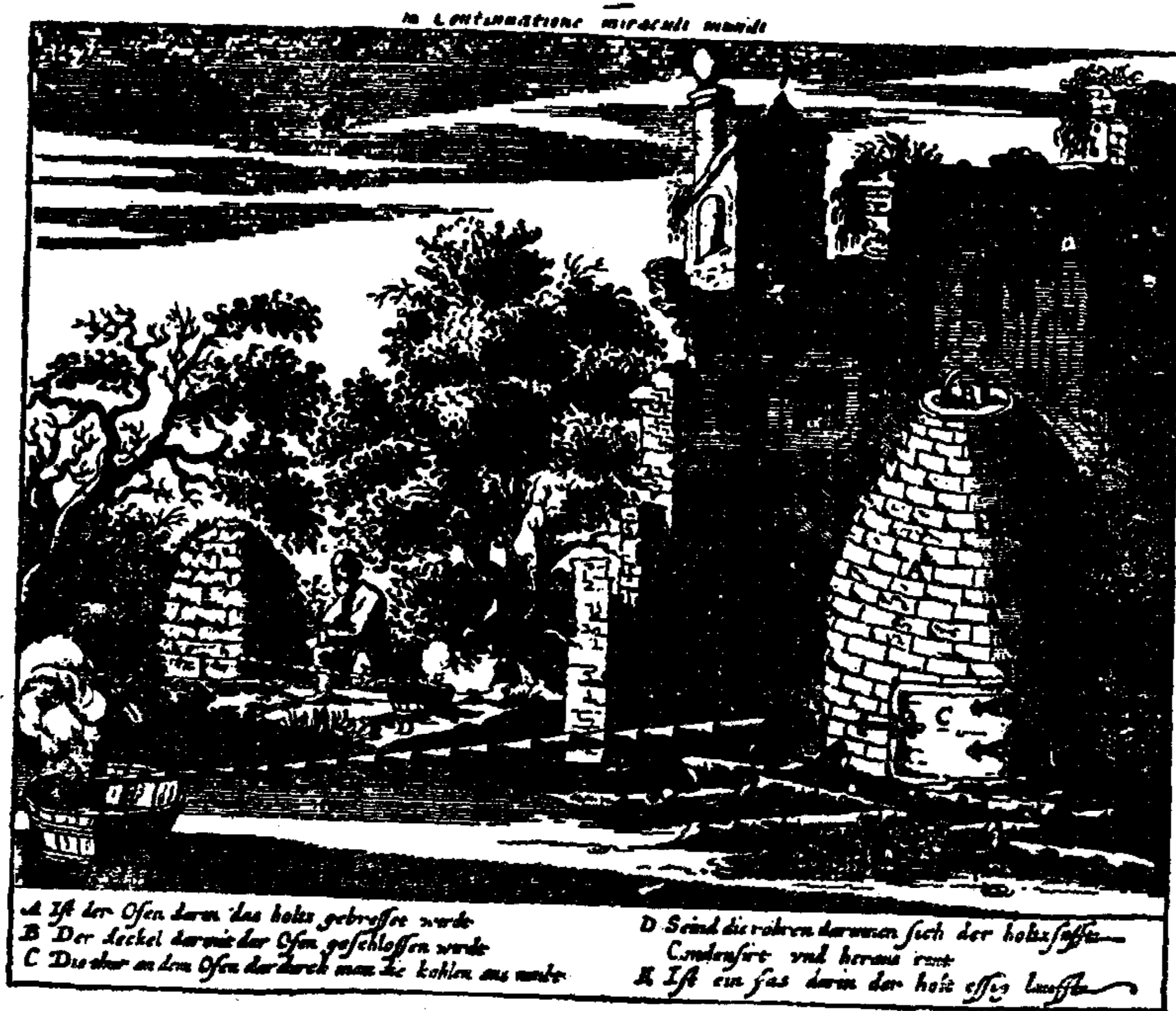
图 31—精馏木精的蜂窝炉(格劳伯, 1657), 注意空气冷凝器和精油收集器。
