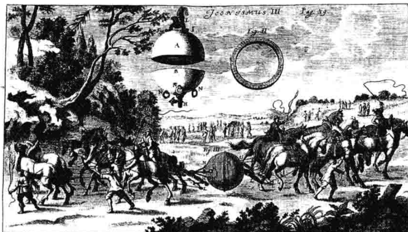
► 这幅铜版画表现的是著名的马格德堡实验：20 匹马正要分开 2 个合拢的、内部已经抽成真空的半球。实验虽未得出什么全新的认识，却令其设计者名声大振。
